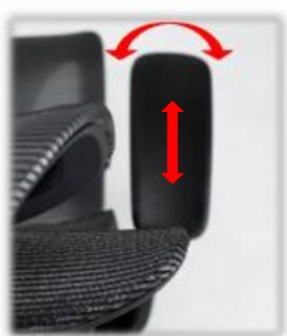
**Nastavení bederní opěry:** bederní opěra podporuje během sezení přirozené zakřivení páteře. Model KLEM umožnuje její vodorovné nastavení v rozsahu 0-65 mm. Směrem vpřed se posouvá pouze tahem opěráku za spodní část a polohy signalizuje zřetelné cvaknutí. Pro pohyb zpět se páka „4“ pootočí po směru hodinových ručiček v pohledu zleva, proti směru z pohledu zprava. Aretace se uvolní a opěrák se zasune do výchozí polohy.
